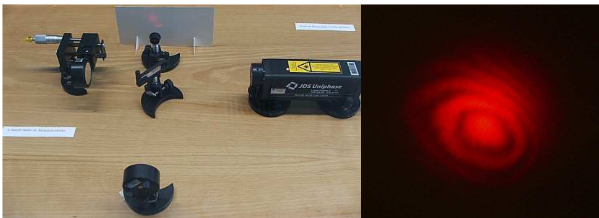
Figura 1.5: Foto de uma montagem experimental de um interferómetro de Michelson moderno, que usa um LASER de luz vermelha e das franjas de interferência obtidas. Adaptada de [4, 3]
